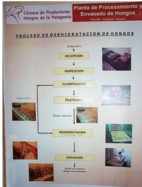
Figura 42b: Diagrama de tareas para la deshidratación de hongos (gentileza: Cámara de Productores de Hongos de la Patagonia. Neuquén - Alto Valle de Río Negro)
