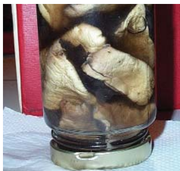
Enfriado y prueba de hermeticidad (se observa que el frasco presentado no posee cierre hermético ya que se mojó el papel).
