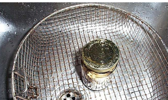
Enfriado y prueba de hermeticidad (se observa que el frasco presentado no posee cierre hermético ya que se mojó el papel).
