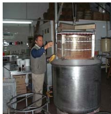
Figura 49: Pasteurizadores para pequeña escala. (a) Uso hogareño; (b) Uso comercial de varios (Gentileza Dulcería Flía. Mengoli. El Bolsón - Río Negro) o de uno solo canasto (Gentileza Establecimiento Masseurbe. El Hoyo - Chubut)
